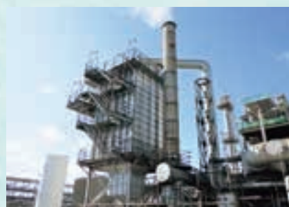
電気集塵機 (排ガス中の微細なばいじんを除去します)
