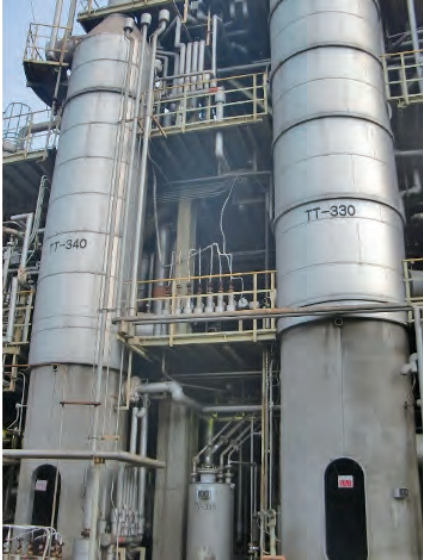
反応条件最適化により蒸気使用量を削減した蒸留塔
