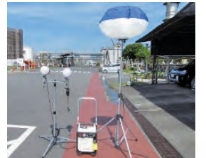
発電機と照明器具
