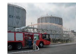
消防車からの放水テスト
