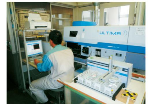
ICPによる有害金属測定
