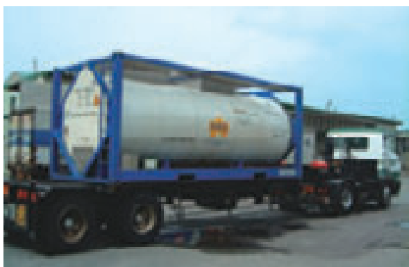
ジメチルアセトアミド専用ISOコンテナ (鉄道輸送拠点までのトレーラー輸送)
