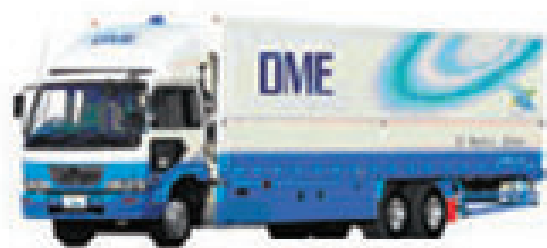
車両総重量20トンの大型DMEトラック
