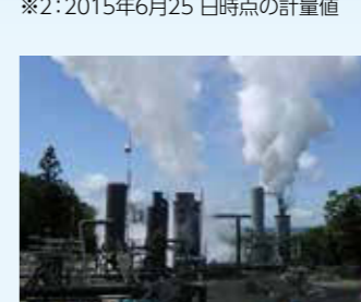
安比地域でのNEDO調査時の噴気試験の様子
