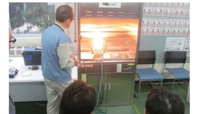
新潟工場にある安全道場での粉体爆発実験
