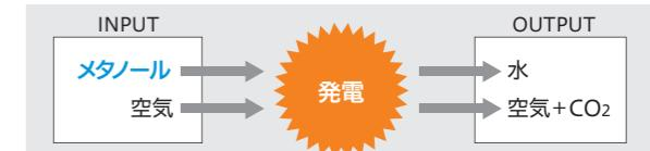
直接メタノール形燃料電池は、メタノールと空気を原料として、化学反応を起し、電気を作ります。メタノールを供給し続ける限り電気を作り出せます。
