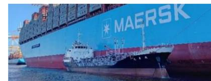
メタノール燃料コンテナ船「Alette Maersk」に Ship to Ship で接している様子
