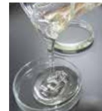
透明ポリイミドワニス「ネオプリム®」は無色透明性と300°C以上の耐熱性を活かし、スマートフォン部材等の情報通信分野での採用が進んでいます。
