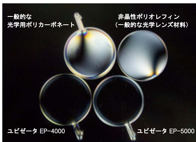
【写真】複屈折の比較（射出成型板の直交ニコル下での光漏れ） 光学ひずみのある部分が、明るく色がついて見える。
